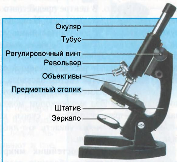
Рис. 8. Световой микроскоп
